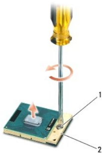
1 ZIF 插槽 cam 螺絲 2 ZIF 插槽
